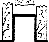
Bild 3 Metall-Profile für die Verbindung von Marinite-Wänden
